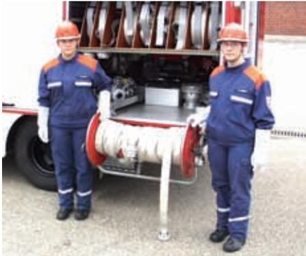
Ein dritter Jugendlicher zieht den Schlauch in seiner Länge gerade (damit die Luft entweicht) und meldet, wenn die Kupplung kommt „Achtung Kupplung“. Erst danach wird ein weiterer C-Druckschlauch angekuppelt und der Vorgang wiederholt, bis die Haspel voll mit fünf Schläuchen bestückt ist
