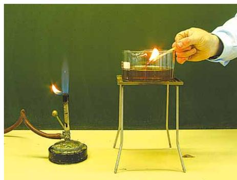
Petroleum entwickelt bei normaler Temperatur zu wenig Dämpfe, um es leicht anzünden zu können.
